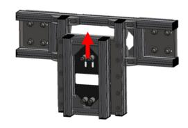
上爪を長穴に沿って押し上げ窓枠の 上部に引掛け、ボルトを締め込みます。
