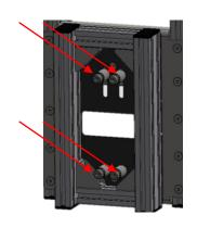
全4本のボルトを締め込み 締結します ※締結トルク:5.2N·m
