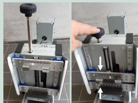
ロッドを押すと爪が上下から閉じてカゴ台車を掴む！
