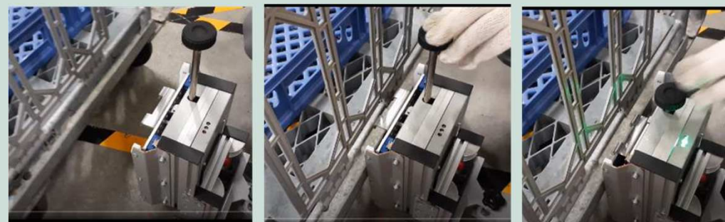
カゴ台車を近づけてロッドを押すだけでチャッキング完了
