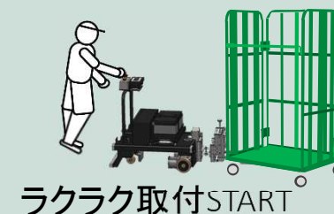
カゴ台車を近づけてロッドを押すだけでチャッキング完了
